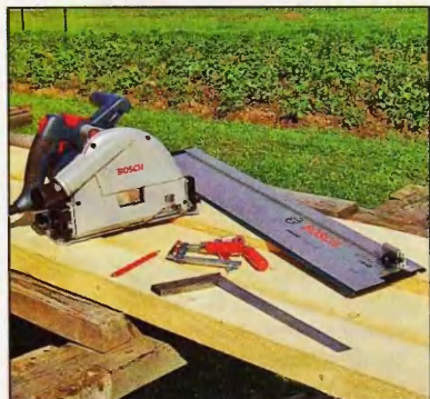
Дисковая пила, направляющая шина и две специальные струбины — этого достаточно, чтобы добиться достойного результата.
