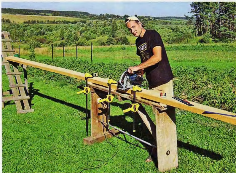
Никогда не стоит забывать, что быстро вращающийся диск инструмента — источник серьезной опасности. Чтобы его не заклинило, обрабатываемая деталь должна быть устойчиво уложена и надёжно закреплена.
