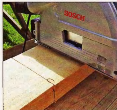
Если рез — черновой, можно выполнить его и по разметке, то есть — без направляющей шины. Тоже получается неплохо...
