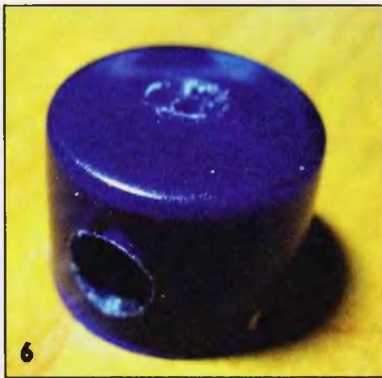
6 В верхнее отверстие корпуса помпы будет вставлен вал моторчика, а из большого нижнего — вытекать вода.
