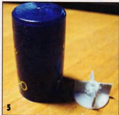
В качестве корпуса для помпы использовал пластиковый колпачок от дезодоранта.
