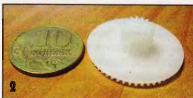
Основная деталь рабочего колеса помпы, которое будет качать воду, — пластмассовая шестерёнка.
