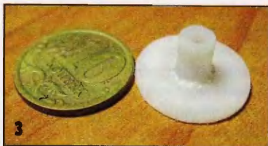
Шестерёнка после обработки под размер корпуса помпы.
